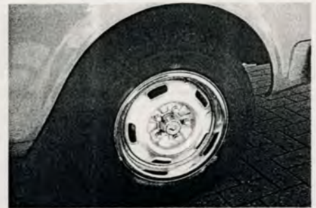
Die Felgen wurden mit Felgenspray versilbert, von dem auch etwas auf die Reifen geraten ist
